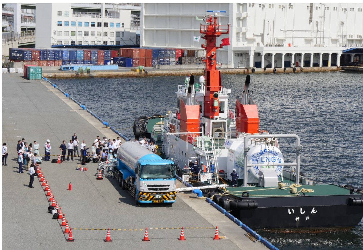
<LNG 燃料供給トライアルの様子>
