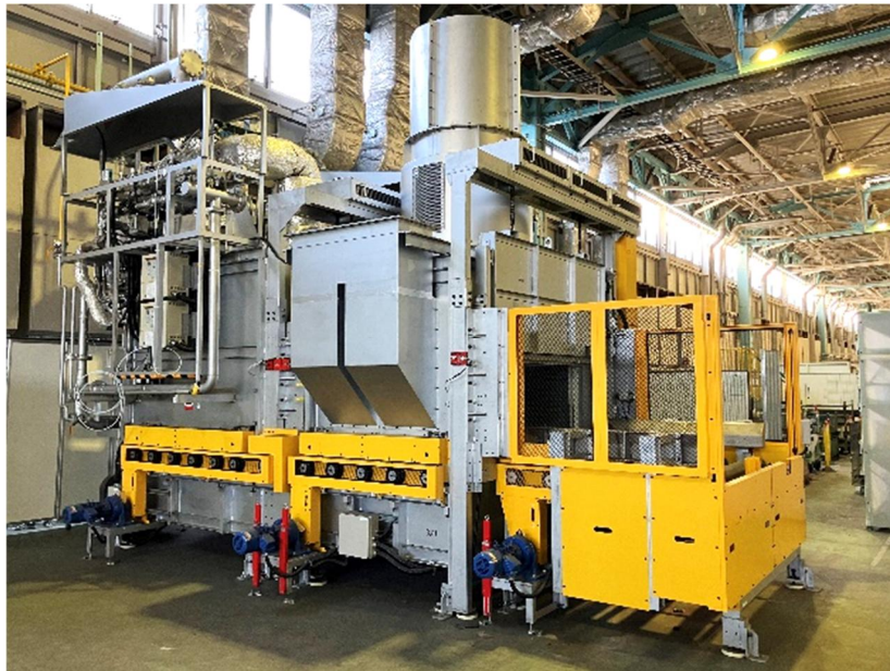
アンモニア燃焼に対応した実証試験炉
