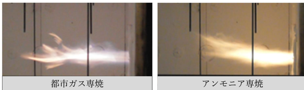
新開発したバーナの燃焼火炎写真 (大阪ガス研究設備で温度・熱量を同条件として燃焼。 いずれも安定燃焼していることが確認できる)
