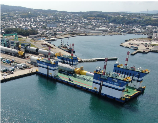
浮体積み込み状況
