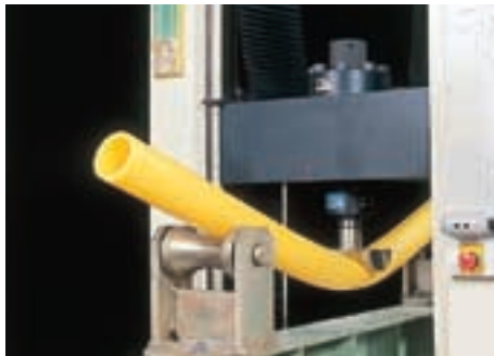
ポリエチレン管曲げテスト
