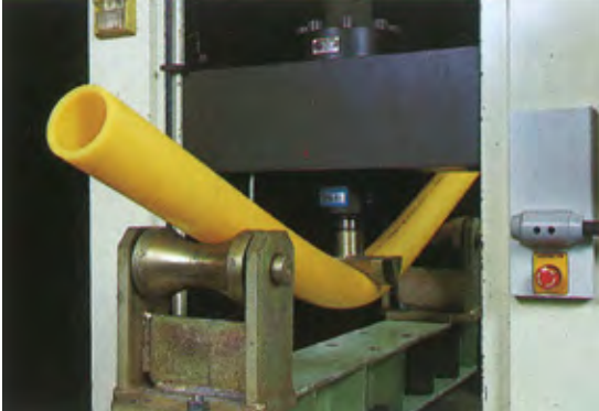
ポリエチレン管の曲げ試験
