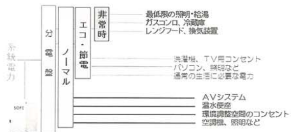
図10 緊急モードを備えた分電盤
