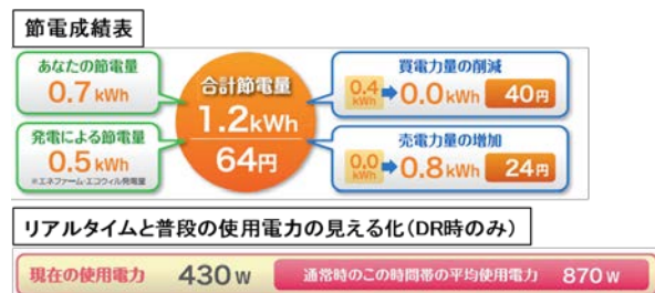
図4 タブレットでの見える化の工夫点例(1年目)
