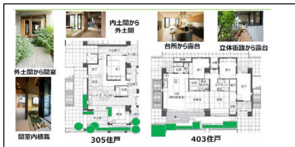
図 8 305 住戸 403 住戸の中間領域における緑地
