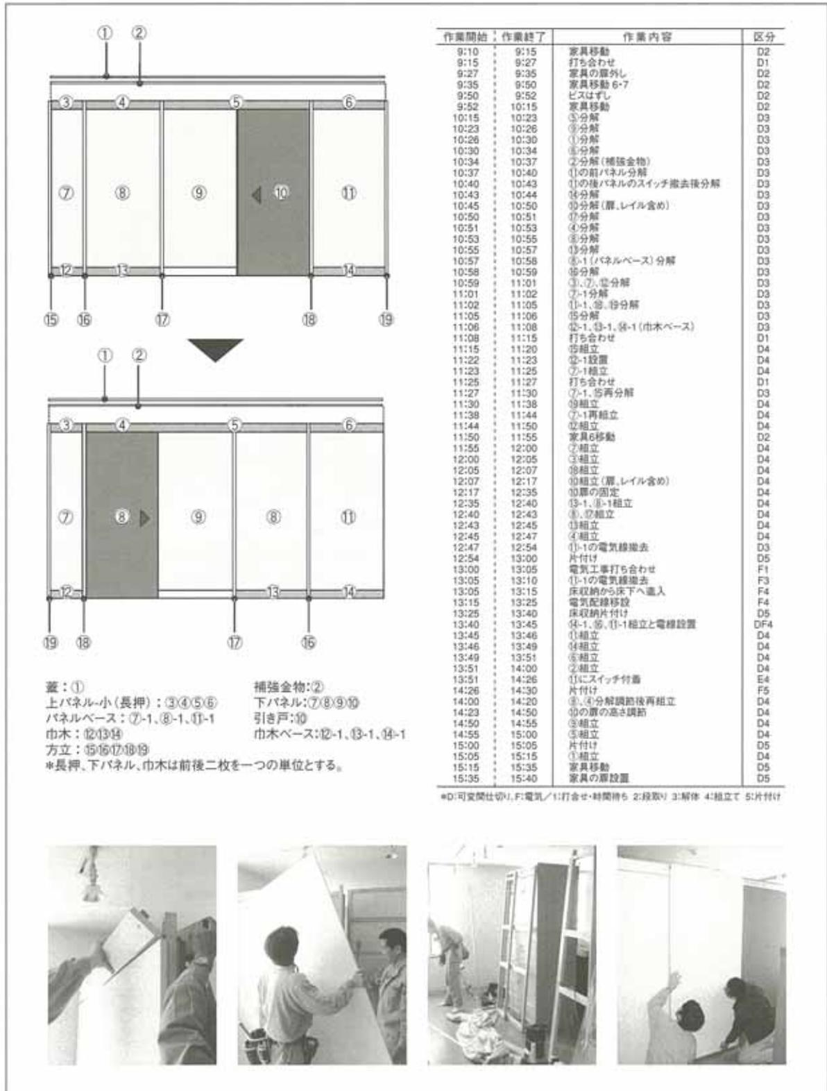
図5：可変間仕切りの移設
