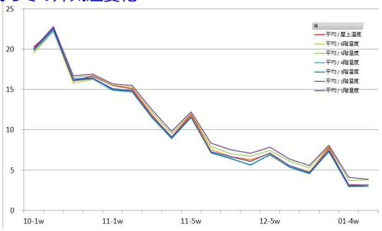
NEXT21の外気温は、屋上の百葉箱で、これまで計測してきましたが、より住戸に近い場所での温度を知るために、2017年度秋より、各階の北側立体街路(共用廊下)に、小型百葉箱を設置し、温度と湿度の計測を開始しました。
